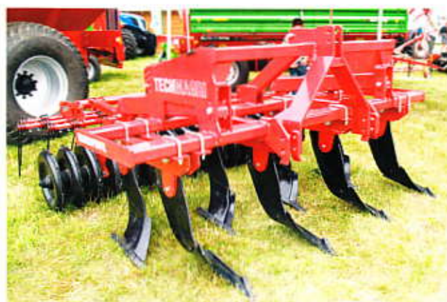
Głębosze Techmagri mogą być wyposażone opcjonalnie w dowolny wał oraz zgrzeblę. Ukośne zęby pracują na głębokości 15–45 cm.
