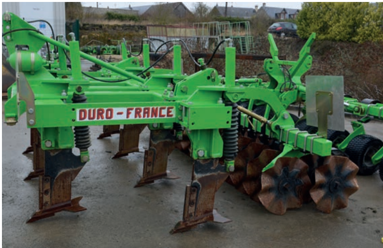
Głębosz dwurzędowy, od którego rozpoczęła się przygoda firmy Duro-France z uprawą pasową. To na jego bazie został stworzony agregat Strip-Till, który można zagregować z siewnikiem, co pozwala na wykonanie nawożenia, uprawy i siewu w jednym przejeździe.
