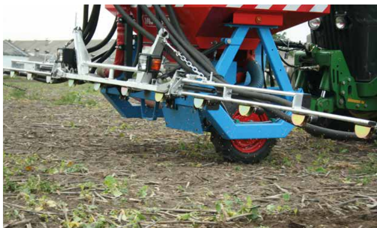
Siew rzutowy Duro France – odbite od płytek rozbryzgowych nasiona są równomiernie rozrzucone na powierzchni gleby.
