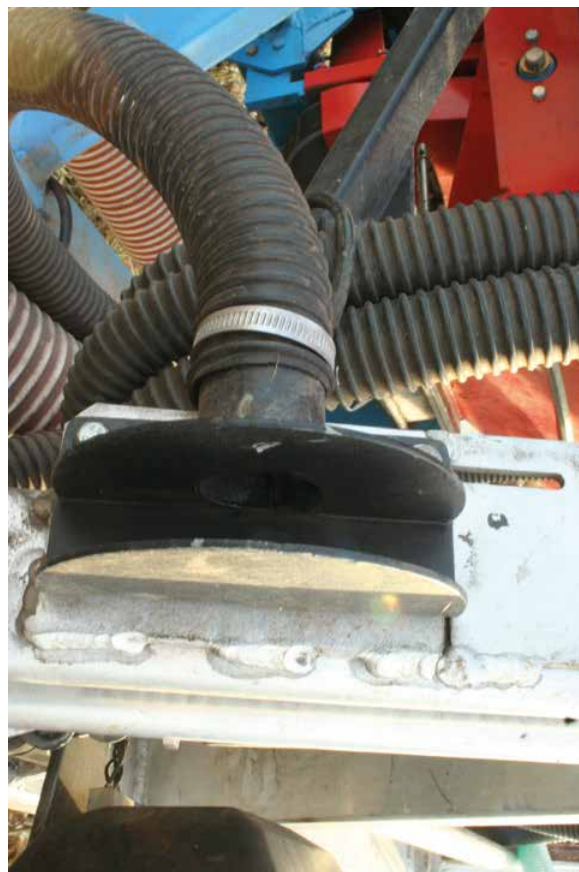
Siew rzutowy Duro France – odbite od płytek rozbryzgowych nasiona są równomiernie rozrzucone na powierzchni gleby.
