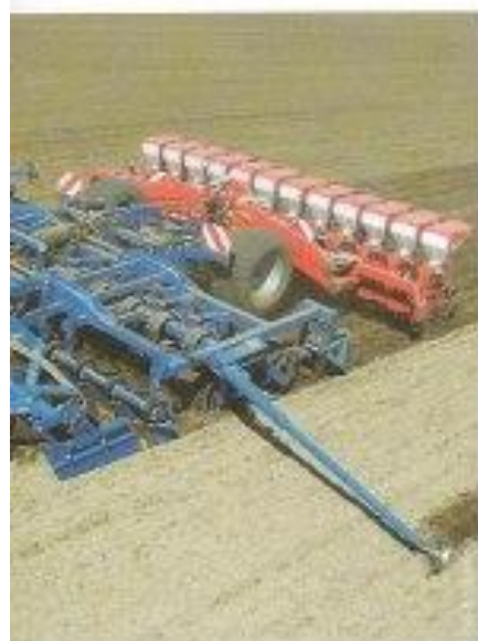
Agregat Kockerling Master jest przeznaczony do uprawy gleby na głębokość do 35 cm z równoczesnym wniesieniem nawozu mineralnego oraz siewu buraków, kukurydzy lub rzepaku.
