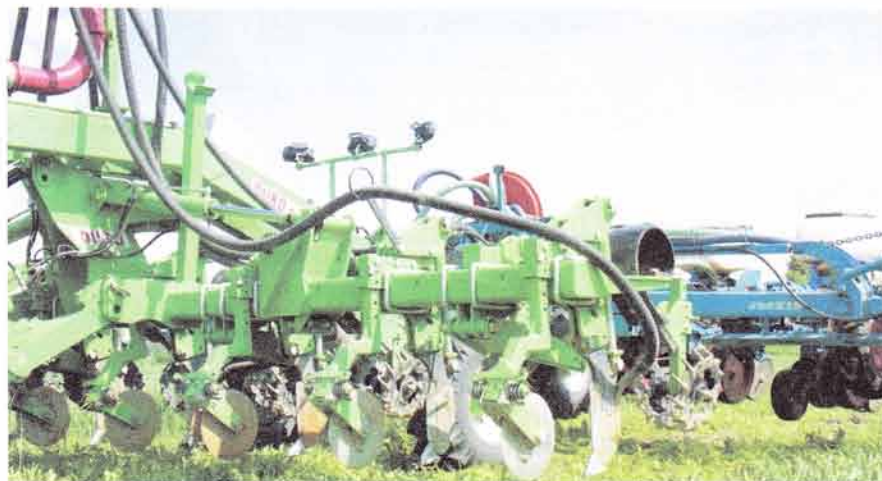
Zestaw Strip-till zastosowany z rozsiewaczem nawozów w jednym przejeździe zapewnia przygotowanie dobrego stanowiska do siewu nie tylko buraków czy kukurydzy, ale także rzepaku.
