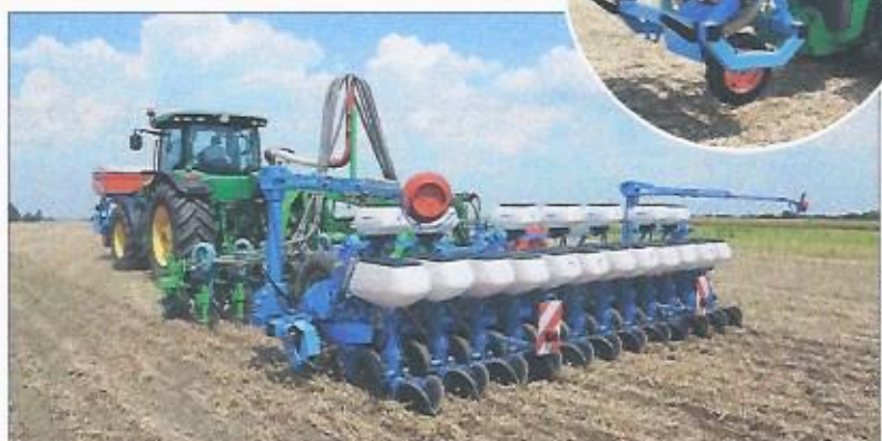
W Kowrozie zboża wysiewane są rzutowo siewnikiem zawieszonym z przodu ciągnika przy pracującym z tyłu agregacie Compil. Gdy ciągnik współpracuje ze spulchniaczem Strip-Till, ze zbiornika podawany jest nawóz
